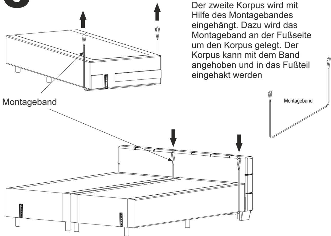
Der zweite Korpus wird mit Hilfe des Montagebandes eingehängt. Dazu wird das Montageband an der Fußseite um den Korpus gelegt. Der Korpus kann mit dem Band angehoben und in das Fußteil eingehakt werden
