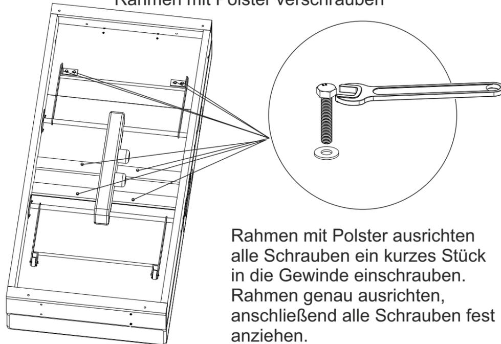
Rahmen mit Polster ausrichten alle Schrauben ein kurzes Stück in die Gewinde einschrauben. Rahmen genau ausrichten, anschließend alle Schrauben fest anziehen.
